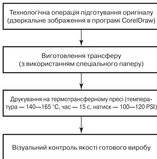
Рис. 2. Блок-схема оздоблення продукції термотрансферним способом друку для технології Magik Touch
